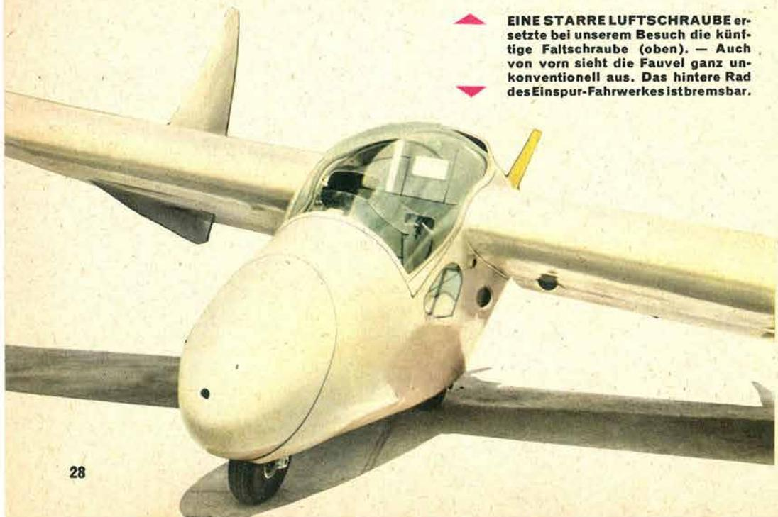
▲ **EINE STARRE LUFTSCHRAUBE** ersetzt bei unserem Besuch die künftige Faltschraube (oben). — Auch von vorn sieht die Fauvel ganz unkonventionell aus. Das hintere Rad des Einspur-Fahrwerkes ist bremsbar.
